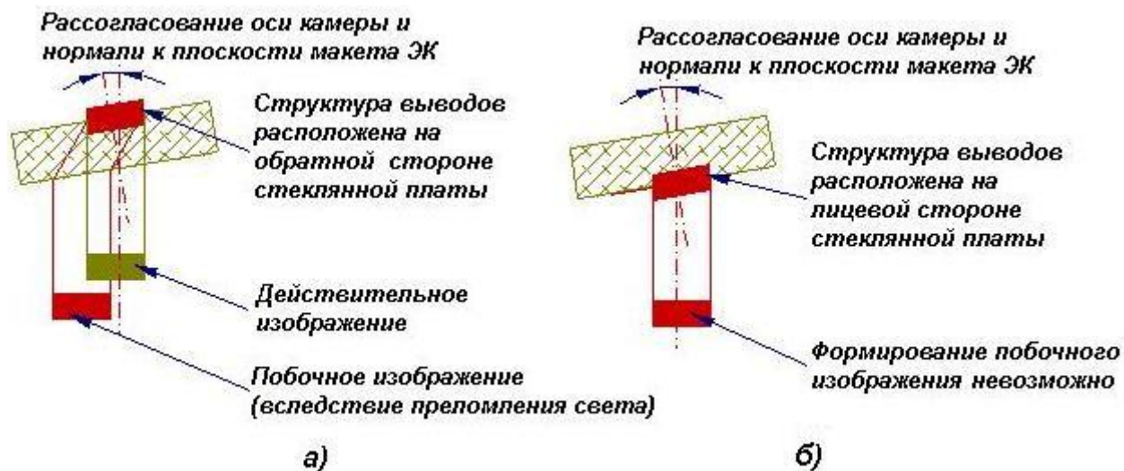
Рис. 14. Влияние расположения стороны платы, на которой расположены изображения выводов из хрома на корпусе макета ЭК, по отношению к позиции камеры СТЗ КИМ на точность формирования изображения: а) изображения расположены на обратной стороне платы; б) изображения расположены на лицевой стороне платы. Рисунок с сайта www.cetaq.com
