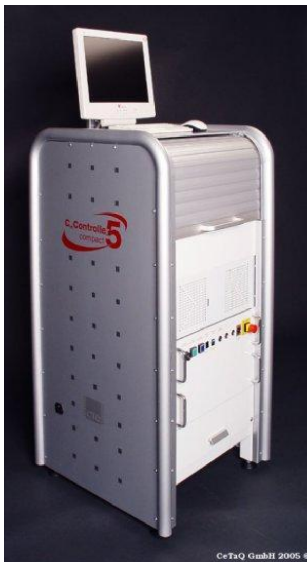
Рис. 10. Внешний вид КИМ CmController 5 Compact производства компании CeTaQ GmbH. Фото с сайта www.cetaq.net
