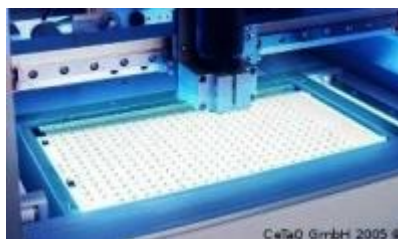
Рис. 11. Рабочая зона КИМ StController 5 в процессе проведения измерений. Фото с сайта www.cetaq.net
