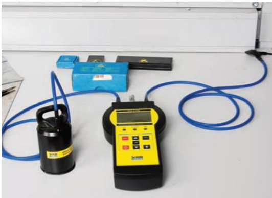
Рис. 7. Измерение сопротивления к точке заземления
