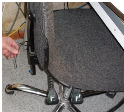
Рис. 2. Антистатический стул с оборванным проводом заземления
