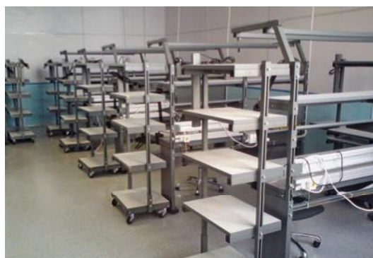
Рис.3. Заземленная мебель в антистатическом исполнении
